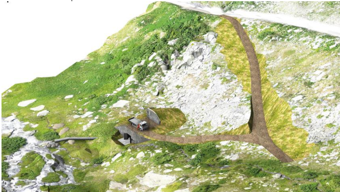
Accès à la centrale et implantation dans la pente et conduite de restitution (AVP Alp'Etudes)
