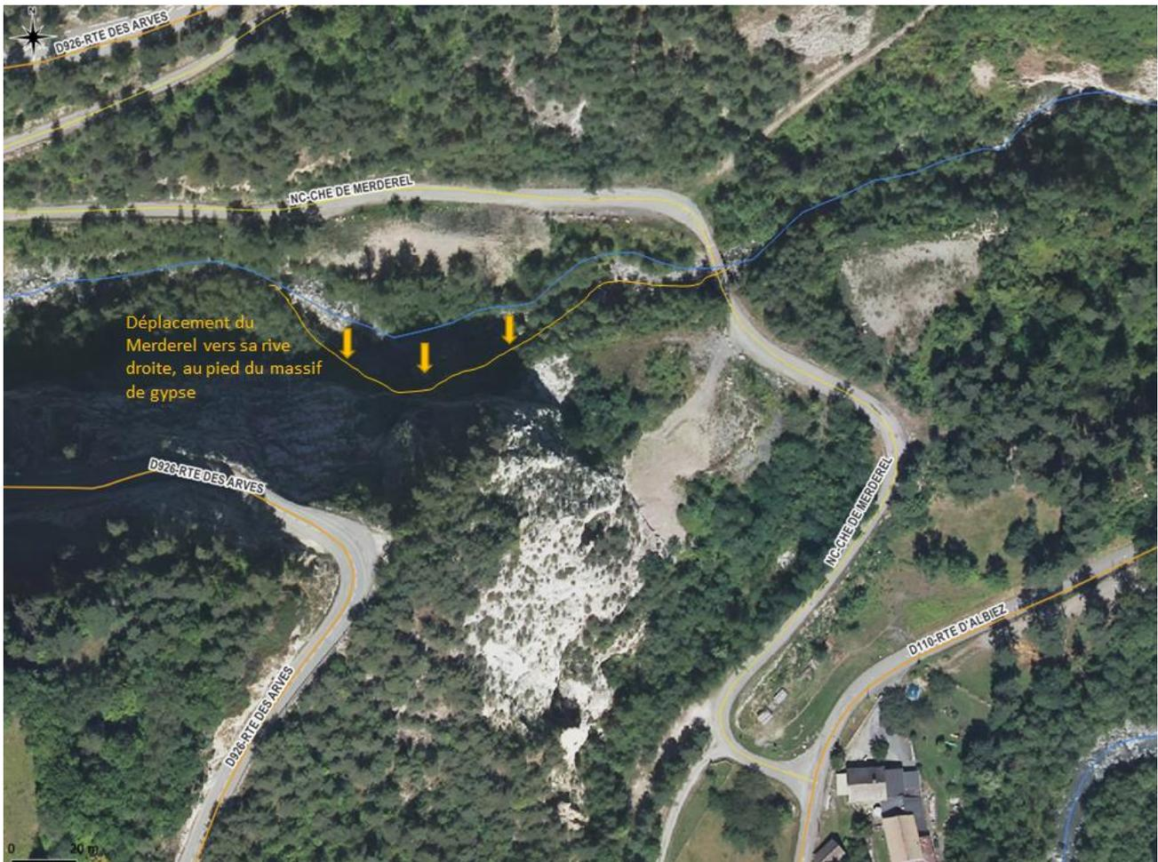
Figure 6 : Déplacement constaté sur site du Merderel vers sa rive droite (tracé actuel en jaune)
