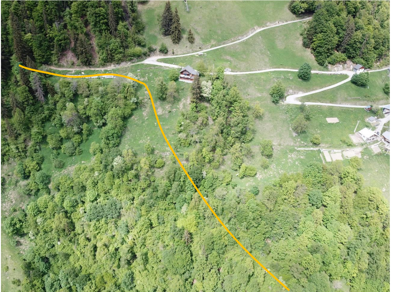
Figure 11 : Vue aérienne avec implantation conduite forcée (4)
