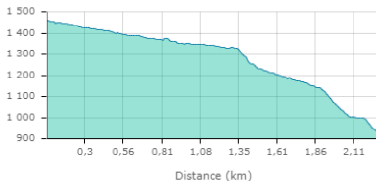
Figure 3 : Profil altimétrique de la conduite forcée
