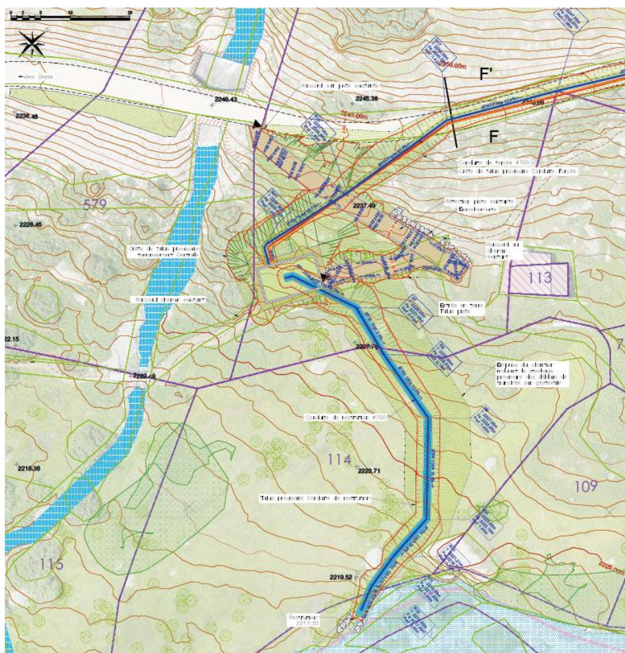
Projet abandonné : la zone humide était traversée par la conduite de rejet enfouie à plus de 30cm sous la surface.
