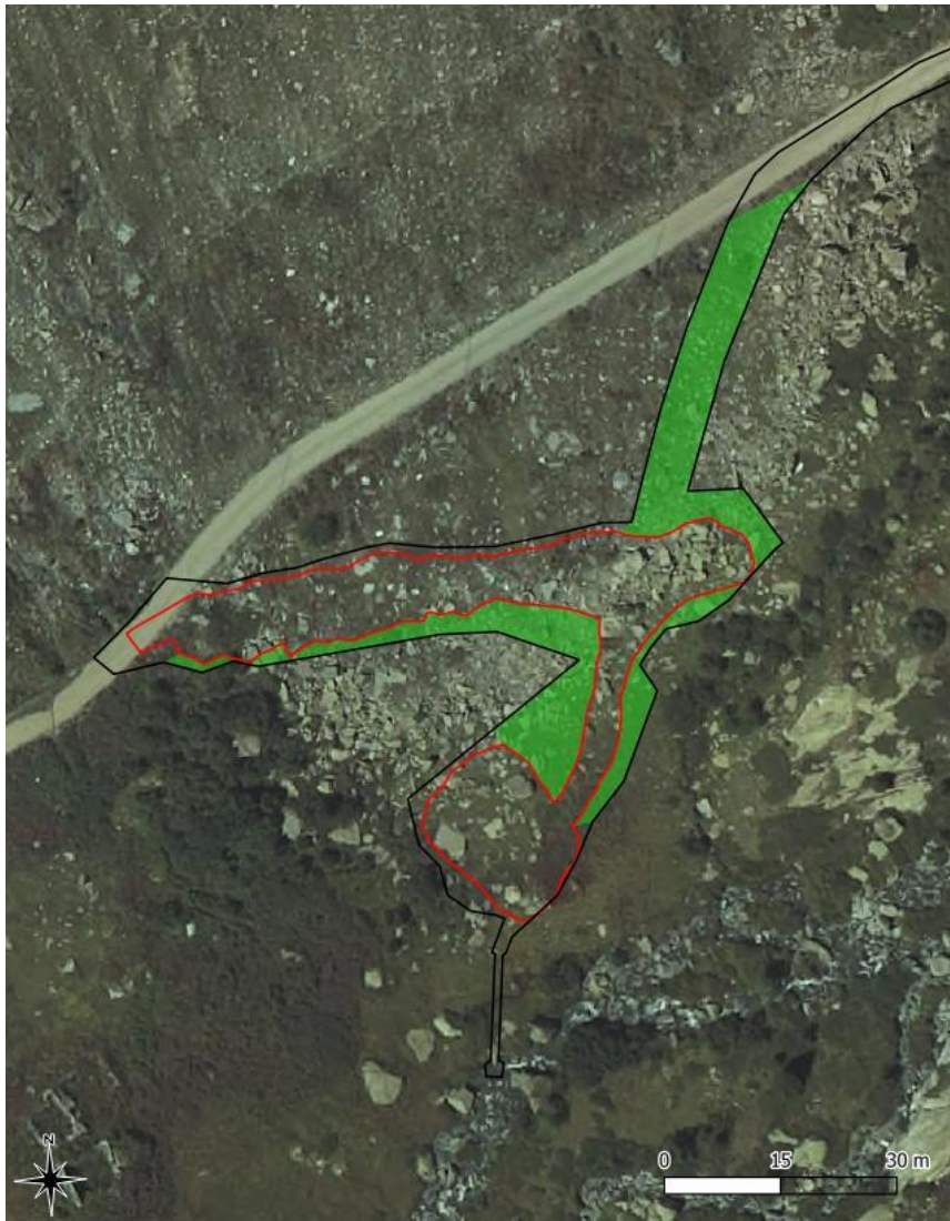
Surface maximale estimée des milieux « Champs de blocs » initialement présent pouvant être remise en l'état après les travaux, soit 1000m 2 . En noir figure l'emprise du chantier et en rouge l'emprise de terrassement de la piste d'accès et de la centrale.
