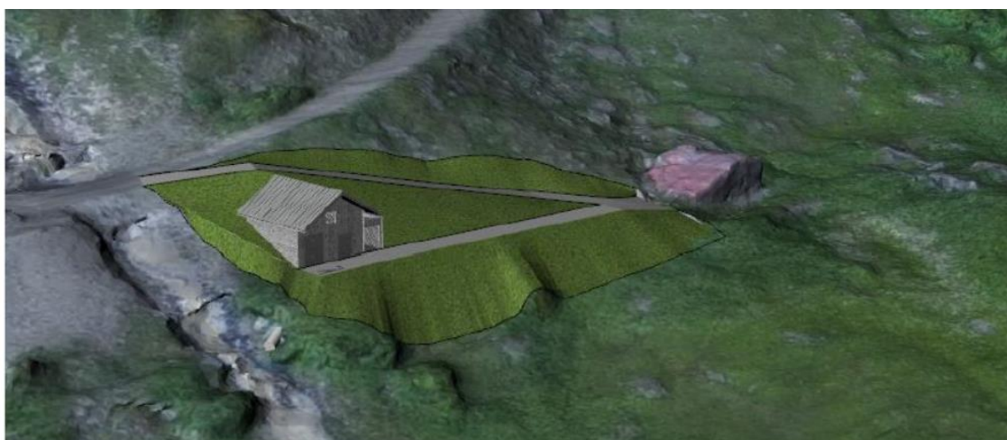
Projet intermédiaire : des terrassements encore conséquents en raison de l'accès à l'usine (débords sur la zone humide à l'aval, gros impacts des terrassements sur les habitats et faible intégration paysagère)
