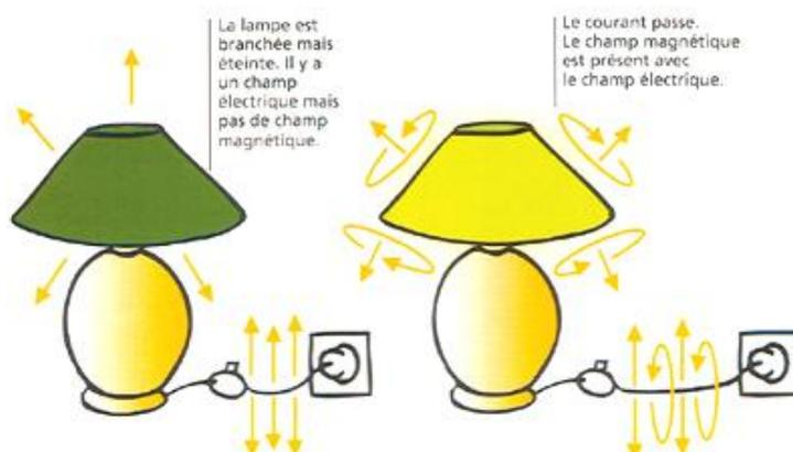
Pour le réseau de transport d'électricité à 50Hz, on distinguera le champ magnétique (CM50) et le champ électrique (CE50).
