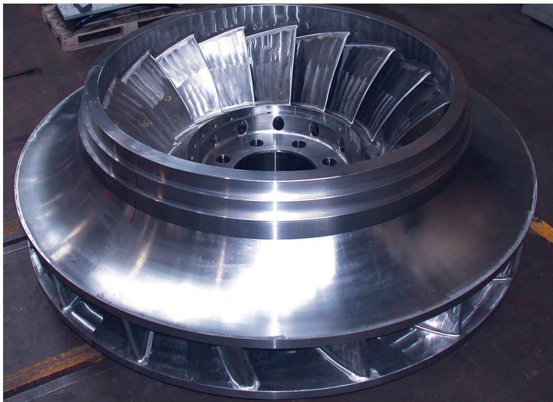
Figure 4: Photographie d'une turbine Francis
