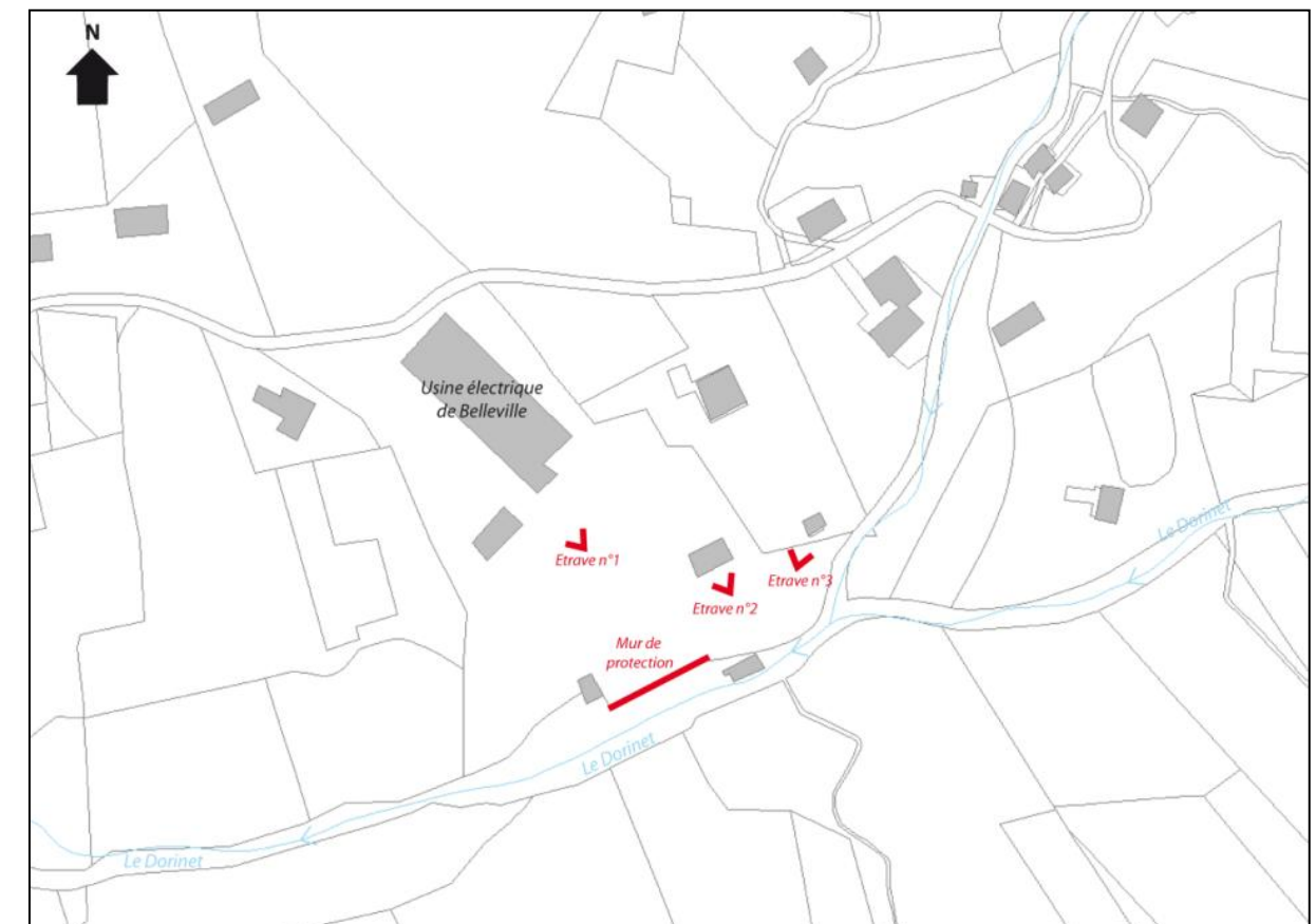
Figure 16 : Position des différents ouvrages de protection au niveau de l'usine de Belleville [Source : IMS RN ]
