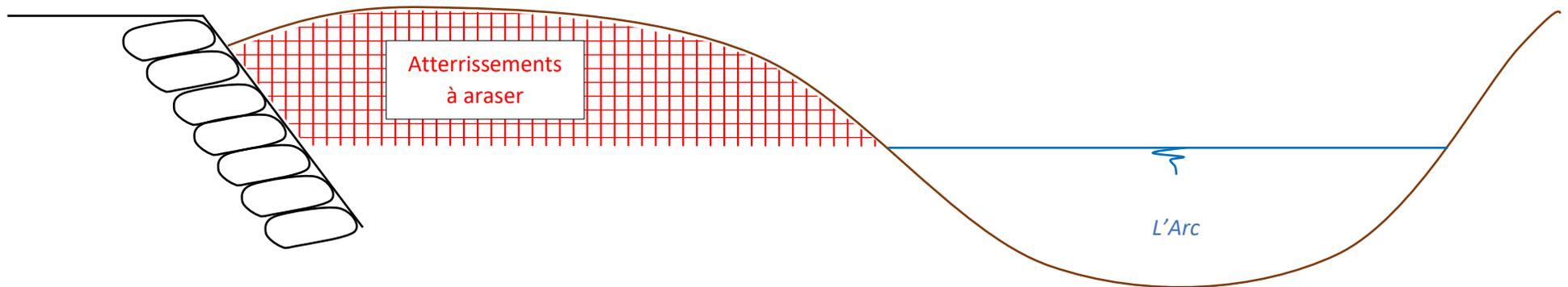
Figure 4 : Coupe type de l'entretien sédimentaire à réaliser
