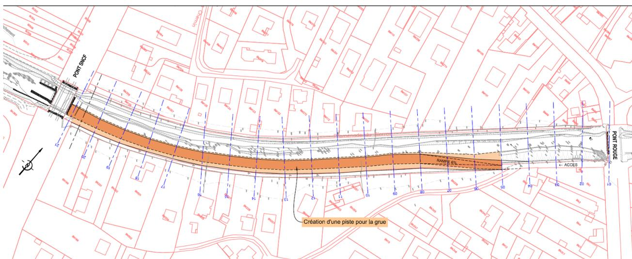
*Figure 13: Piste d'accès de la grue rive gauche (Source: PRO Safège, avril 2018)*
