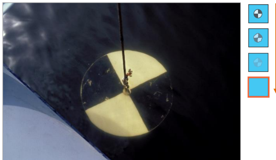
Figure 36 : Utilisation du disque de Secchi
